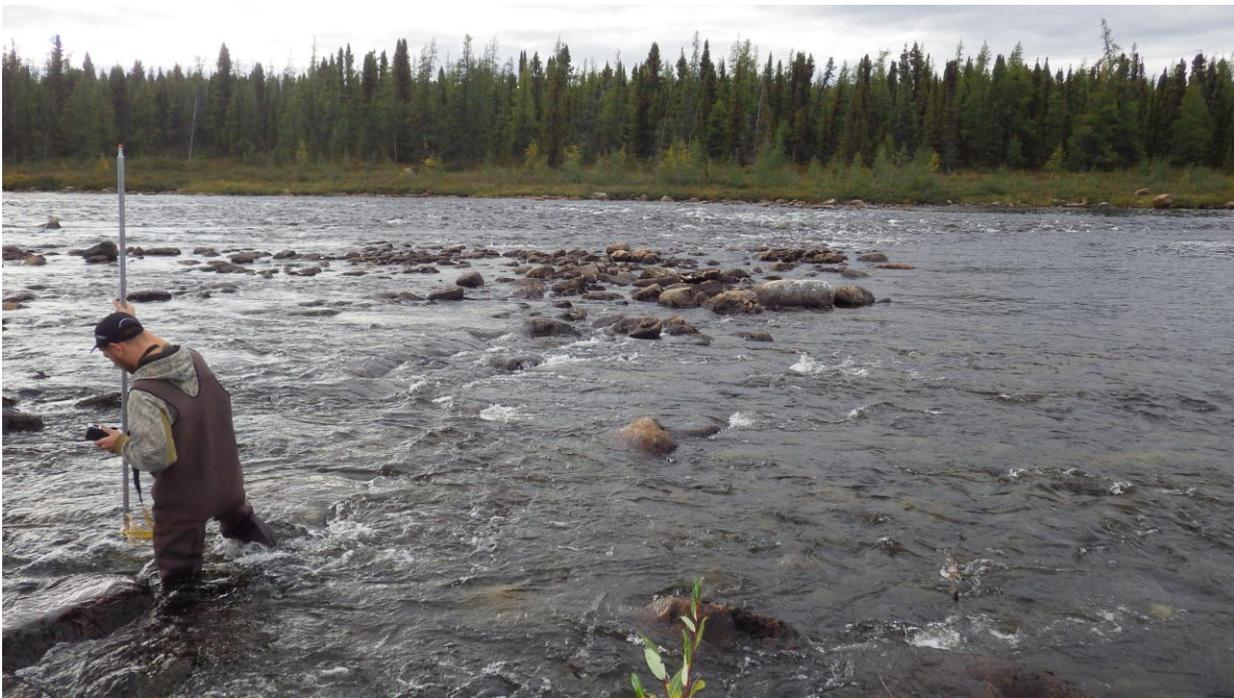
Figure 10. Mesure de la vitesse du courant.
